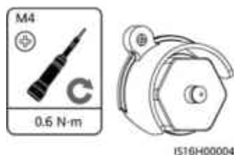
Figure 5-35 Installation des composants antivol du Smart Dongle
